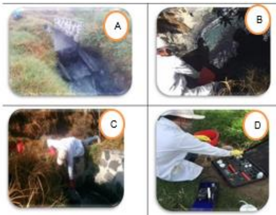
Figura 3. Efluente textil (A), toma de muestra de ART (B y C) y medición de análisis físicos y químicos insitu (D).
