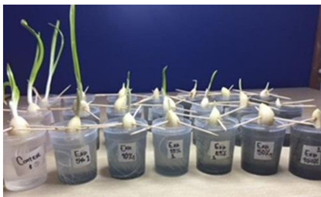
Figura 4. Exposición del ajo ( A. sativum ) a diferentes diluciones de agua residual textil compuesta (ARTC).
