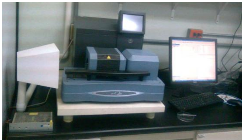
Figura 4.6. Equipo TGA/DSC marca TA Instruments modelo SDT Q600.
