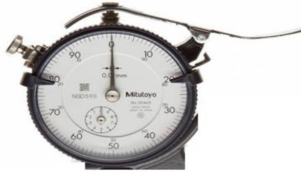
Figura 45. Micrómetro Manual marca Mitutoyo® ocupado para obtener datos de espesor de las láminas de vinil.
