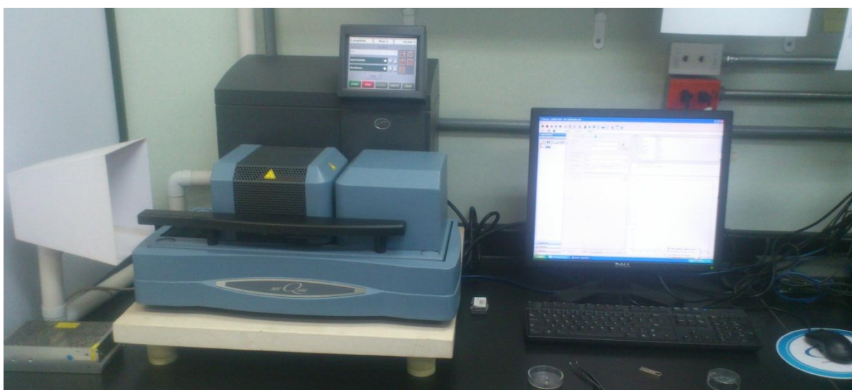
Figura 16. Equipo simultáneo TGA/DSC modelo SDT Q600 de TA Instruments.
