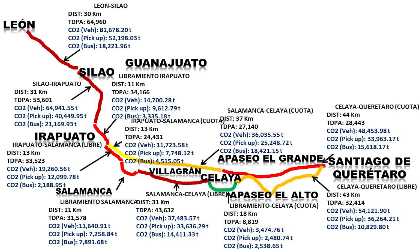
Figura 4-5 Mapa de emisiones contaminantes de vehículos tipo A y B en el tramo de estudio
