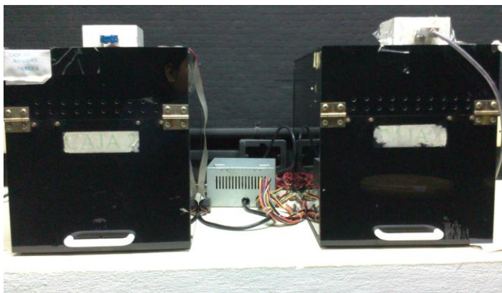
Fig. 24. Cajas de actividad motora. El haz de luz infrarroja producido por los ocho fotodiodos, permite registrar los movimientos y desplazamientos de los sujetos de experimentación. Laboratorio de Neurofarmacología.
