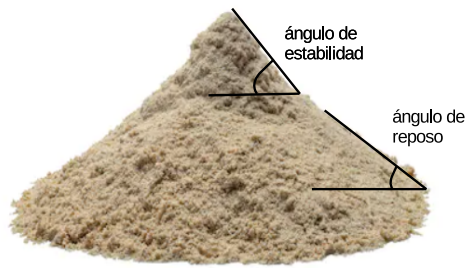
Figura 1.7: Ángulo de estabilidad y ángulo de reposo en un montículo de granos secos [13].
