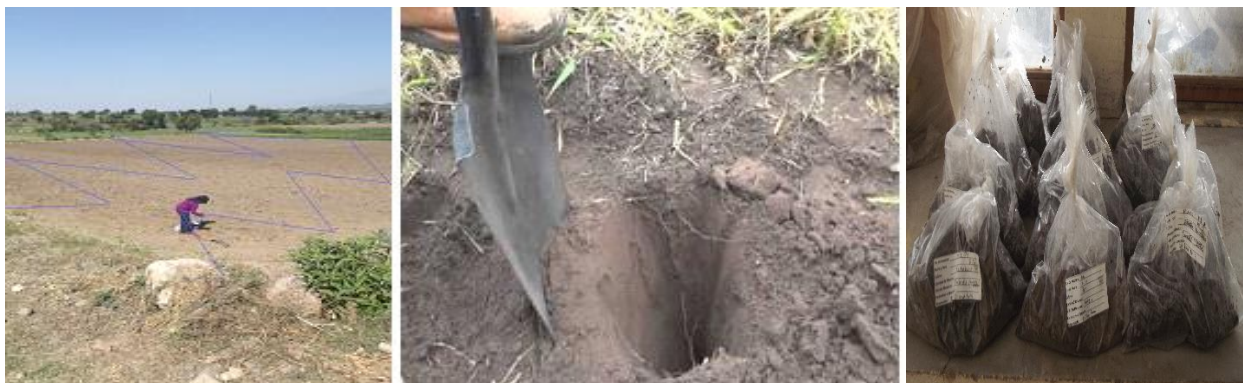
Figura 26. Toma de muestras de suelo. a) Muestreo en zigzag, b) Profundidad, c) Almacenamiento (elaboración propia).
