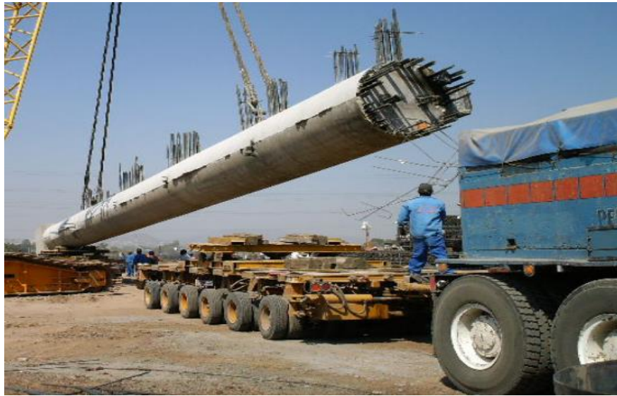
Figura 11. Transporte tipo módulo direccional de 6 ejes.
