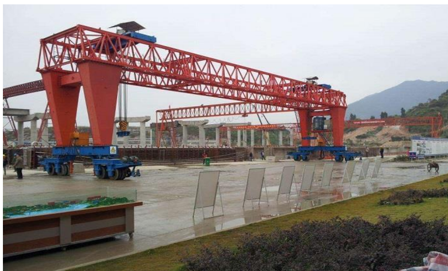
Figura 14. Pórtico de gran capacidad para montaje de prefabricados
